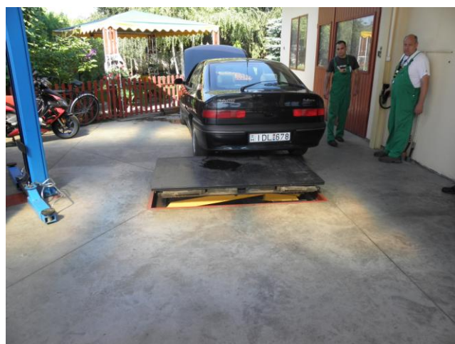
...megoldódott a levegős emelő szintbe történő süllyesztése is
